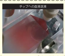
■ポリマーCTC チップは、微細なポストを多数配置した流路からなり、その表面に抗体を固定できます。がん細胞に特有の抗原(捕捉ターゲット)に対する抗体を用い、流路を流れる血液からがん細胞だけを選択的に表面に捉えることができます。
